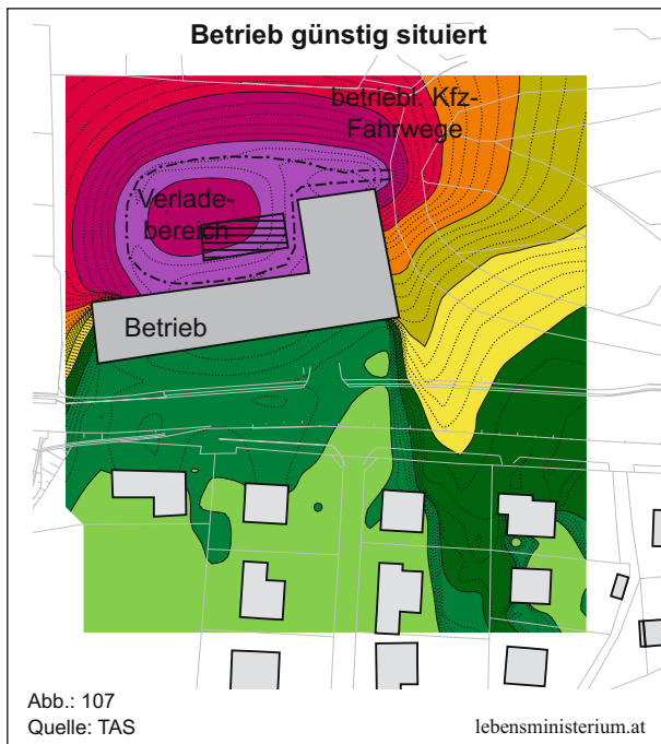
Abb. 106 zeigt eine exemplarisch angenommene Betriebsanlage, deren relevante Abstrahlflächen inklusive der vorgelagerten Manipulationsflächen im Freien anrainerzugewandt sind. Die in 5 dB-Klassen dargestellten Schallpegel verdeutlichen die Schallausbreitungsverhältnisse im Beispiel.
