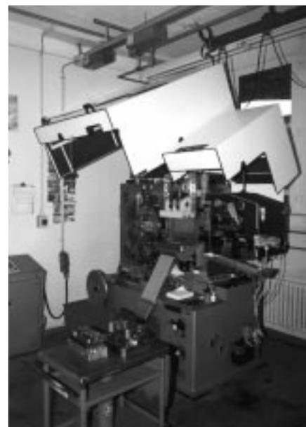
Abb. 2: SONO – Kompaktabsorber in der Stanzerei bei der Firma Madag AG.
