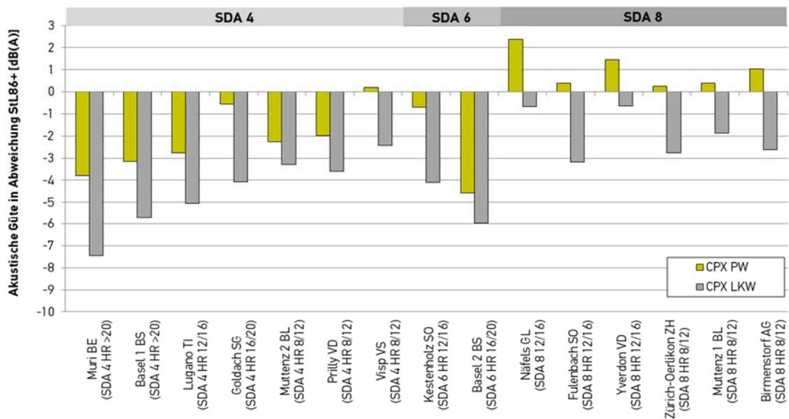
Abbildung 16: Akustische Wirkung der Testbeläge 2015/2016 in Abweichung zum Modell StL86+ in dB(A).
