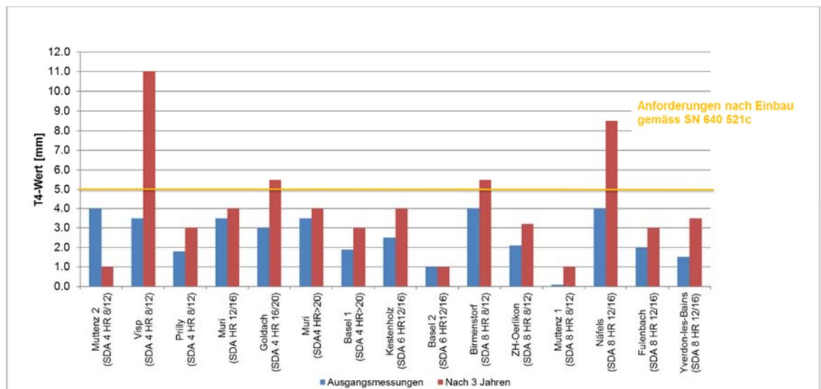
Abbildung 25: Vergleich der Ausgangswerte der Querebenheit (T4-Wert) unmittelbar nach dem Einbau und nach 3 Jahren
