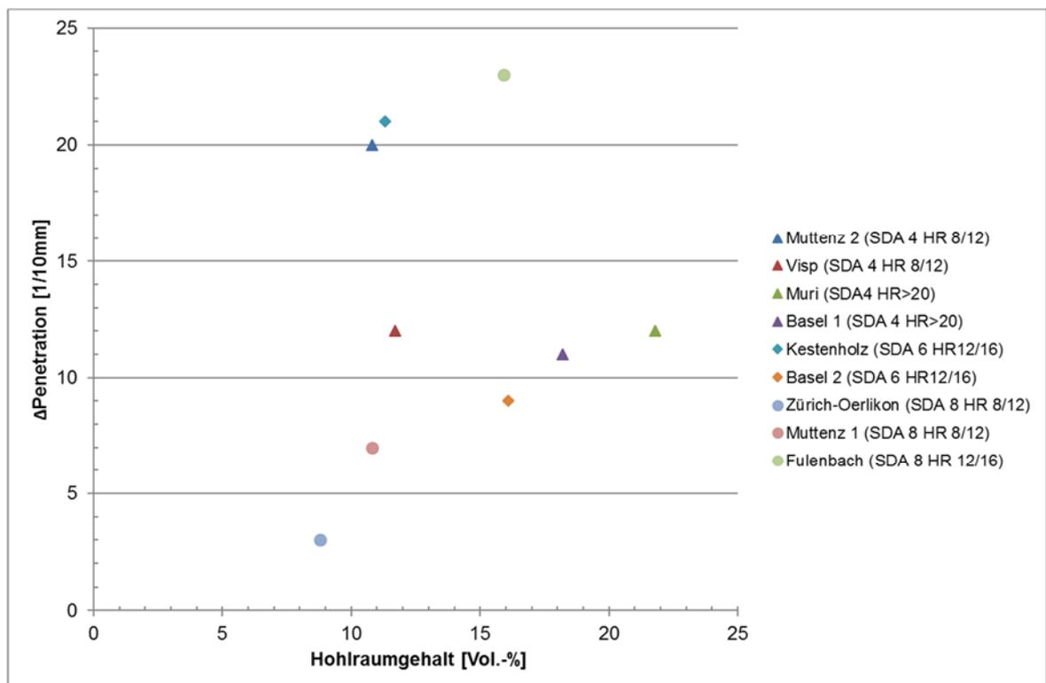
Abbildung 32: Veränderung der Penetration des Bindemittels ( $\Delta Pen$ ) in Abhängigkeit vom Hohlraumgehalt der Bohrkern-.
