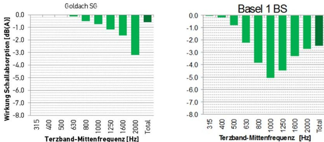
Abbildung 15: Lärmreduzierende Wirkung durch Schallabsorption
