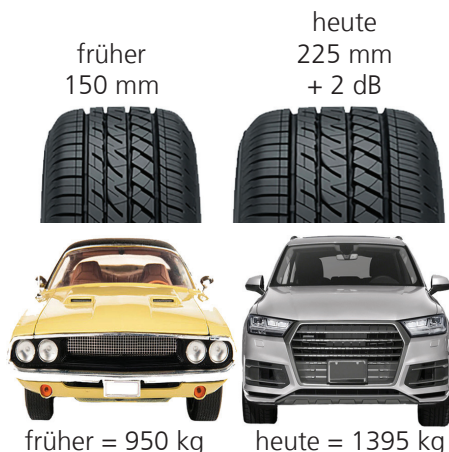
Abb.1: Reifendimensionen und Leergewicht eines Standard-Personen-wagens von früher und heute
