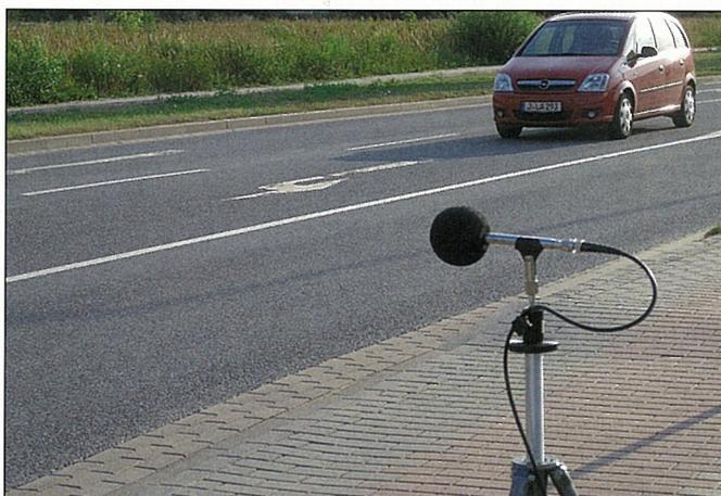
**Bild 1** Mikrofonanordnung für die Vorbeifahrtsmessung.
