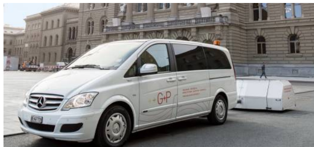
Abbildung 1: Close-Proximity (CPX) Messanhänger von Grolimund + Partner AG nach Norm ISO/FDIS 119-2:2016
