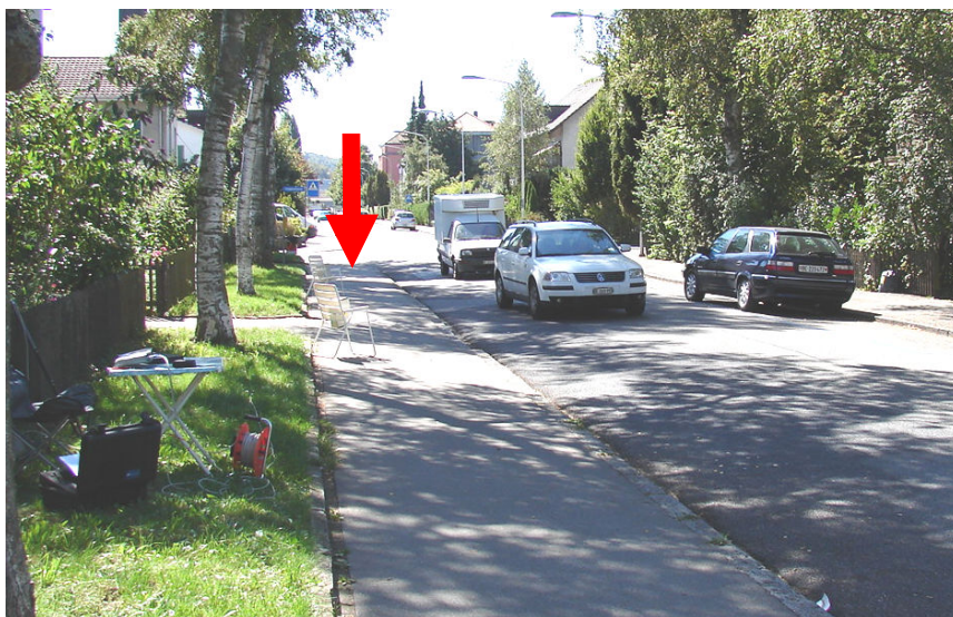
Abb. 5.4: Radar- und Lärmmessungen am Strassenrand
