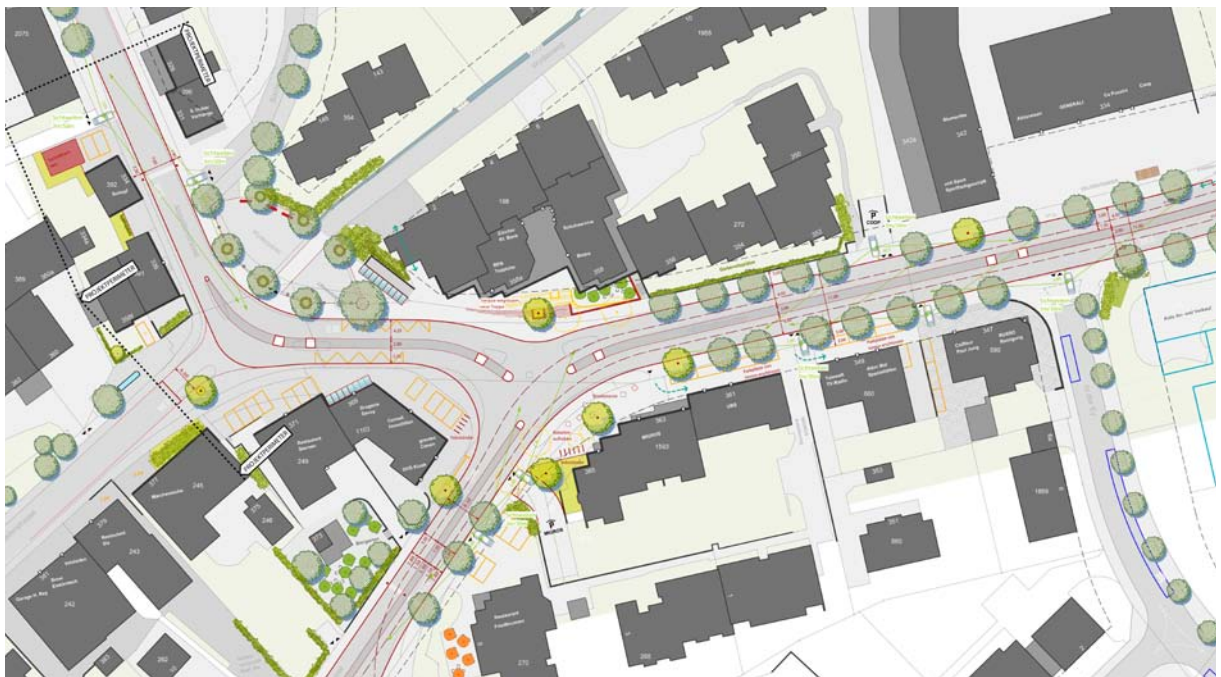
Abb. 10 Planungsstudie Albisrieden: Aufwertung nach dem Koexistenzprinzip (Bedürfnisse der verschiedenen Anspruchsgruppen werden gleichermassen berücksichtigt) und zukünftiger Zustand mit Tempo 30.
