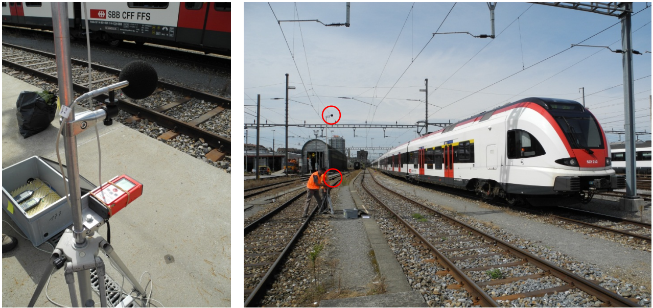
Abbildung 2: Messequipment und -durchführung der FLIRT-Messungen im Abstellbereich Bahnhof Basel.
