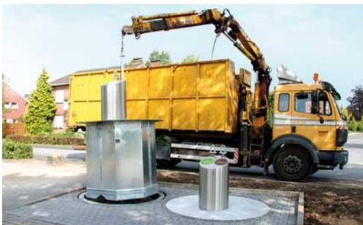
Abbildung 9: Anheben Unterflurcontainer
