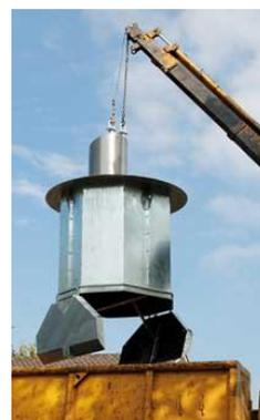
Abbildung 10: Entleeren Unterflurcontainer
