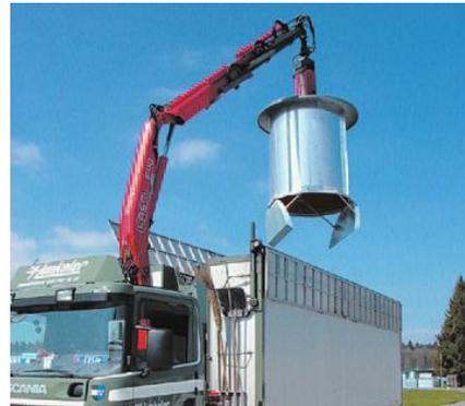
Abbildung 8: Entleerung Halbunterflursystem
