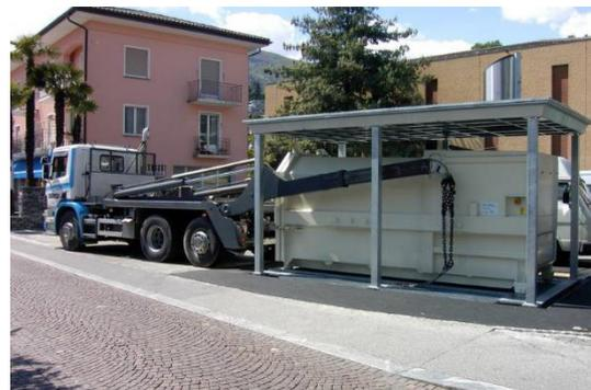
Abbildung 14: Unterflursystem auf hydraulischer Plattform mit Grosscontainer
