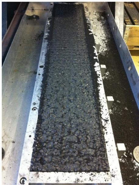
a. Fahrbahnoberfläche nach 100'000 Zyklen bei 40°C
