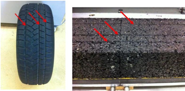
**Abb.25** Längsrillen des Reifens C-L-DK-Si (siehe Tabelle 8) und deren Abdruck auf den Probeplatten nach 20'000 Überrollungen und Prüfkörpertemperatur von 35°C
