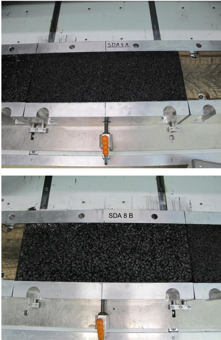
**Abb.38** Visuelle Begutachtung der Versuchsplatten SDA 4 C und SDA 8 B nach 2'000 Überrollungen
