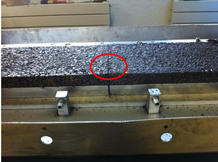
**Abb.15** Prüfplatte mit Kornausbruch nach 100'000 Zyklen mit den Versuchsparametern  $T = 30^{\circ}\text{C}$  und Schlupf = 15%
