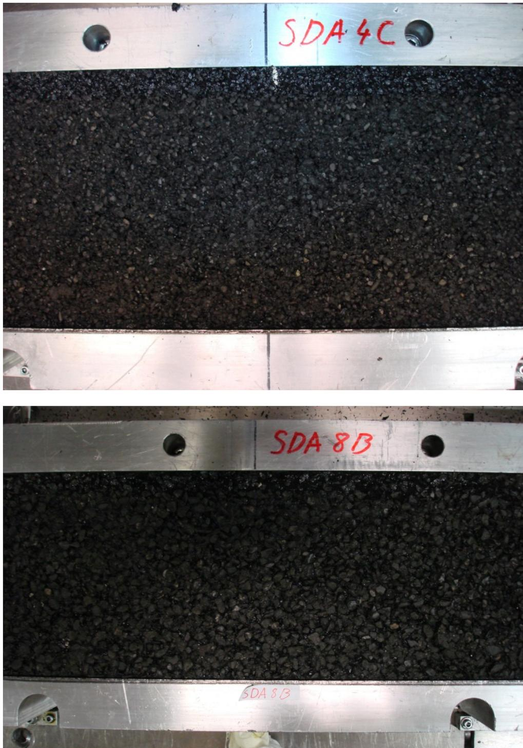
**Abb.40** Visuelle Begutachtung der Versuchsplatten SDA 4 C und SDA 8 B nach 3'552'000 Überrollungen
