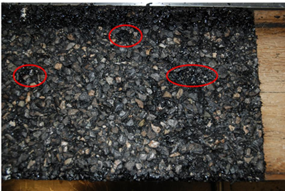
**Abb.23** Versuch mit 4% Schlupf. Erkennbar Kornausbruch auf der Plattenoberfläche
