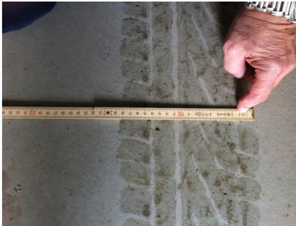
Aufstandsfläche eines 225/55 R16 Reifens mit P= 2.2 bar
