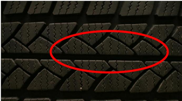
**Abb.16** Reifenprofil mit unterschiedlich grossen Profilklotzen (Pitching)
