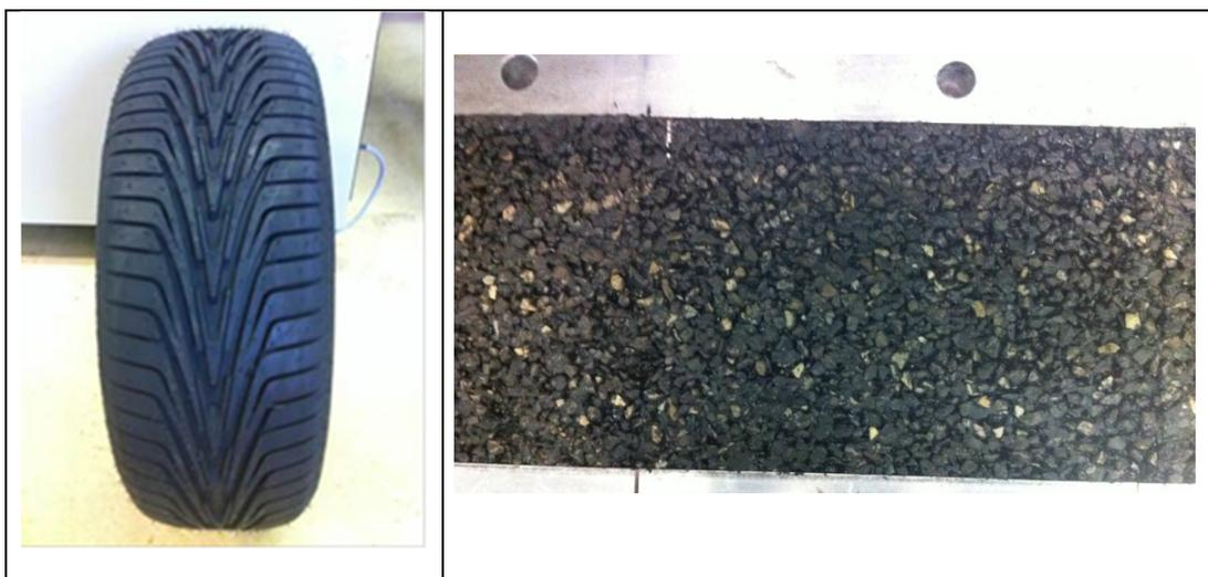
**Abb.26** Prüfreifen mit der Bezeichnung „V-Markt“ und Prüfplatte nach 400'000 Überrollungen; es sind weder Längsrillen, noch sich wiederholende Abdrücke ersichtlich
