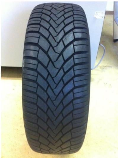
**Abb. 21** Von Hand geschnittener Reifen mit der Bezeichnung „C-V-DK-Si“
