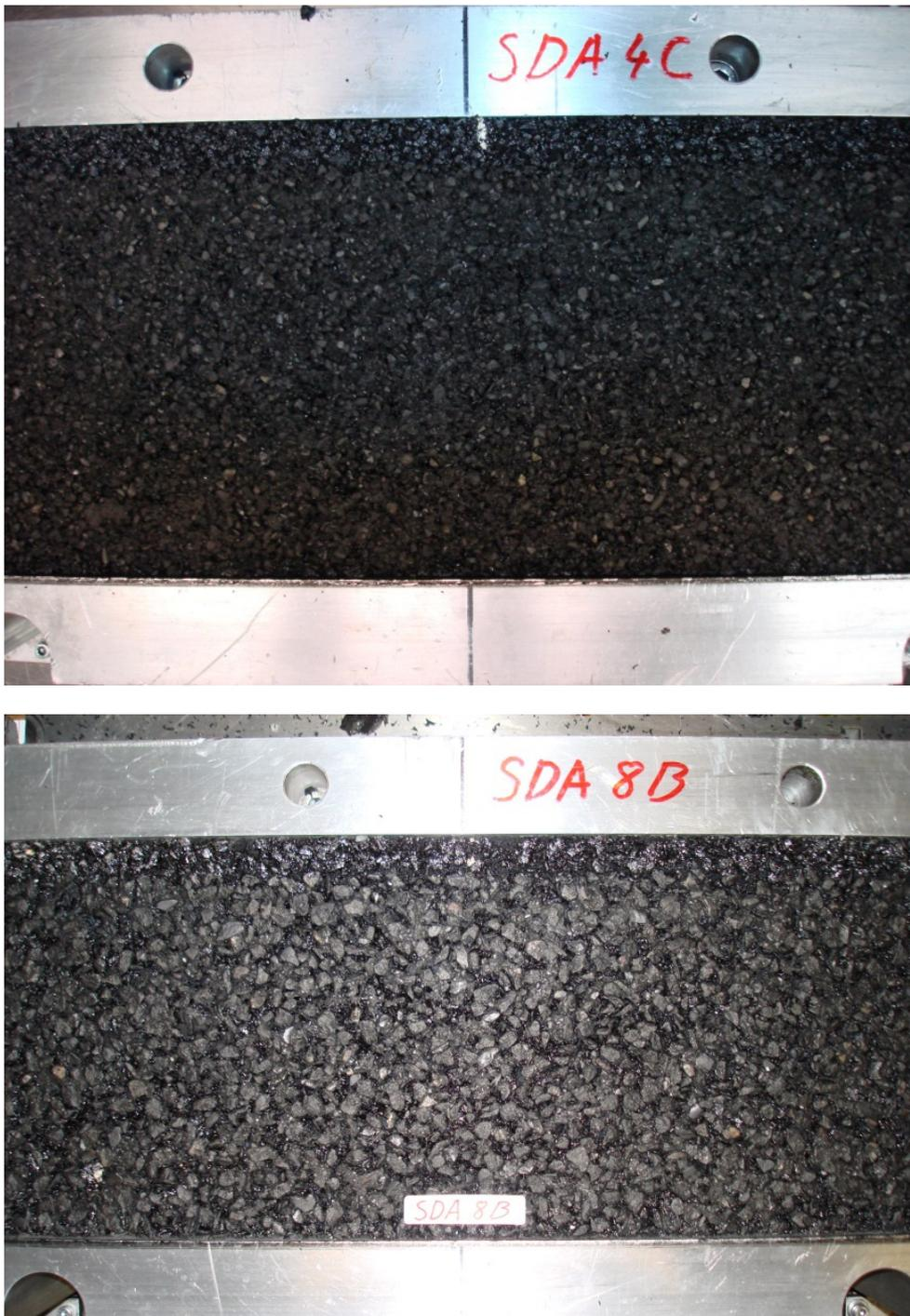
**Abb.39** Visuelle Begutachtung der Versuchsplatten SDA 4 C und SDA 8 B nach 2'200'000 Überrollungen
