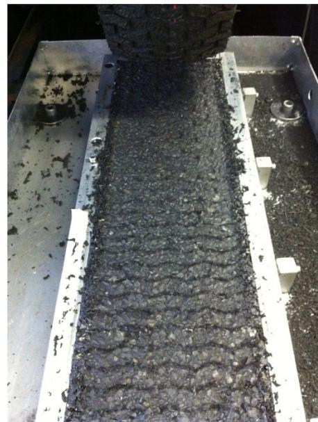
b. Fahrbahnoberfläche nach 100'000 Zyklen bei 50°C
