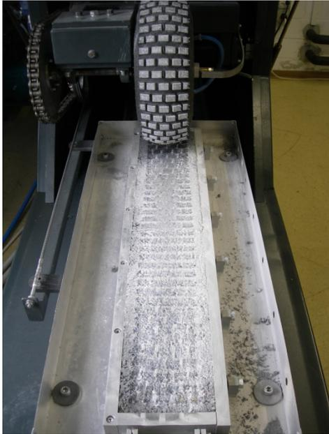
**Abb.7** Dank dem Bestäuben der Reifen mit Talkpulver vor dem Abrollen auf dem Asphalt konnte die Aufstandsfläche sichtbar gemacht und ausgemessen werden.
