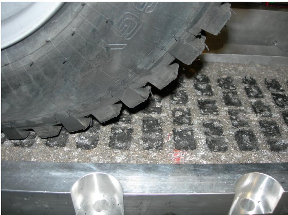
**Abb.8** keine gleichmäßige Beanspruchung der Oberfläche infolge der Verwendung eines ungeeigneten Reifens ohne Schlupf
