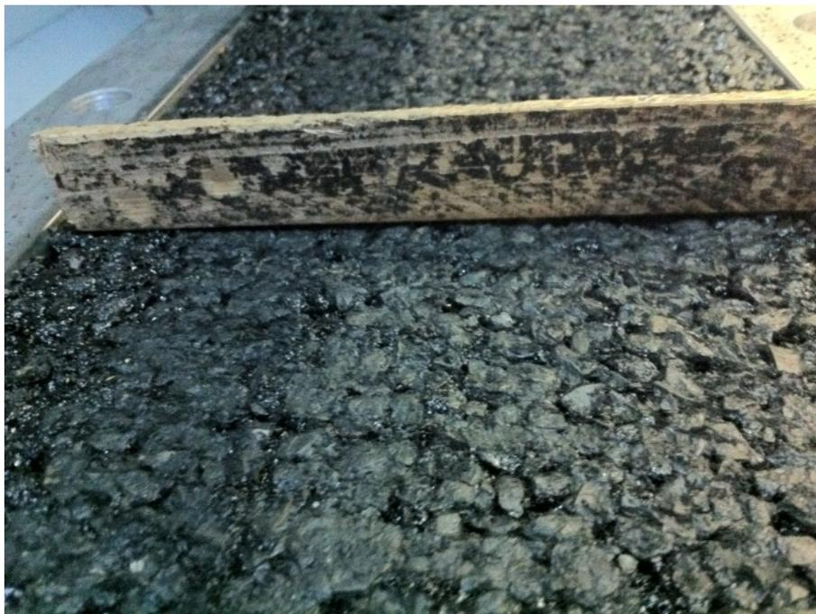
**Abb.24** Spurrillenbildung bei einer Prüftemperatur von 50°C nach 15'000 Überrollungen
