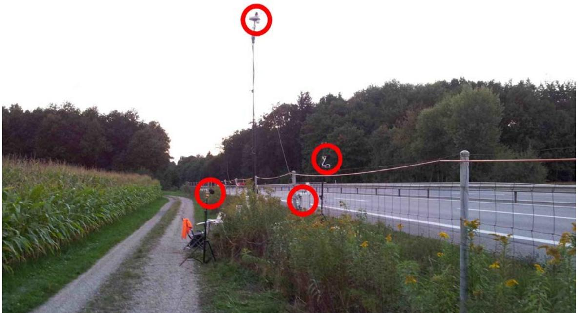
**Abb. 82** Situation am Messpunkt des Ringversuchs bei der Messung durch die Müller-BBM Schweiz AG. Im Vordergrund das Radarmessgerät zur Geschwindigkeitsmessung, links und rechts die SPB-Messmikrofone, oben die Wetterstation und das Mikrofon der Dauermessstelle, die teilweise verdeckt ist.
