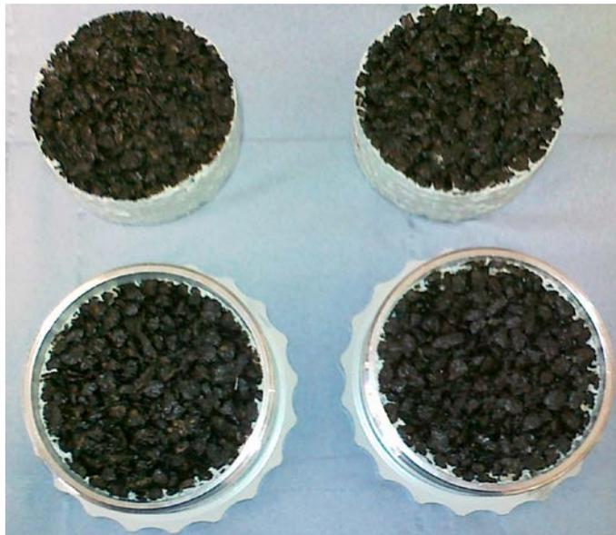
**Abb. 144** Probekörper des Experiments zum Trocknungsverhalten. Gezeigt sind SMA-LA 2 (links oben), SMA-LA 1 (links unten), PA 2 (rechts oben) und PA 1 (rechts unten).
