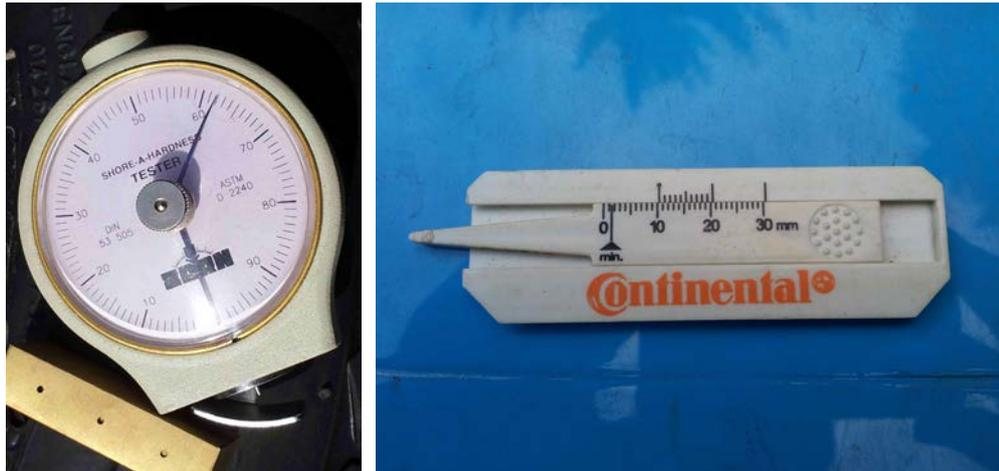
**Abb. 49** Handgerät zur normgerechten Messung der Shore-Härte (links) und Profilmesser (rechts).
