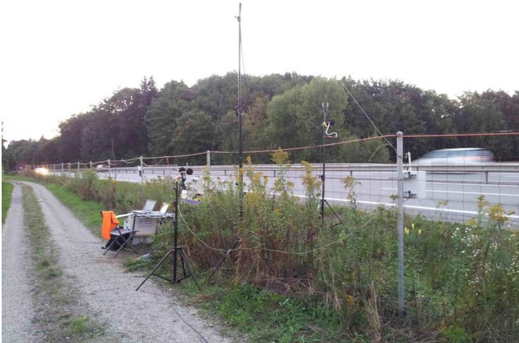
**Abb. 108** Situation am Messstandort bei der Doppelmessung durch die Müller-BBM Schweiz AG. In der Mitte etwas verdeckt das leicht verdrehte Radarmessgerät, rechts das korrekt orientierte Gerät zur Geschwindigkeitsmessung. Mittig links und rechts die SPB-Messmikrofone, wobei auf jedem Stativ zwei Mikrofone montiert waren. Ebenfalls mittig die beiden Messrechner.
