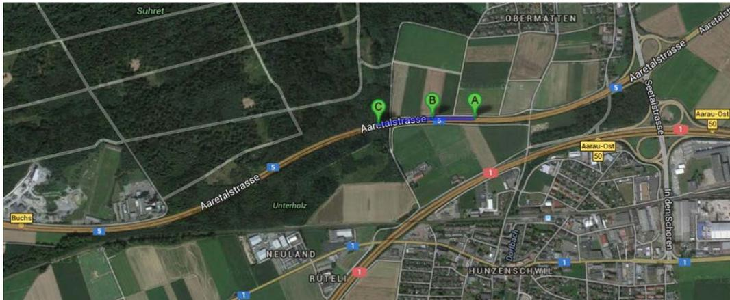
**Abb. 13** Messstrecke Aaretalstrasse mit MR8+ zwischen A und B und MR8 zwischen B und C.
