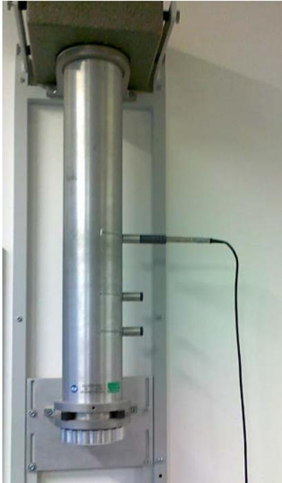
**Abb. 145** Impedanzrohr zur Messung des akustischen Absorptionsgrads. Lautsprecher oben im Gehäuse, die Öffnungen rechts nehmen Messmikrofone auf, der Probekörper ist unten angeschraubt.
