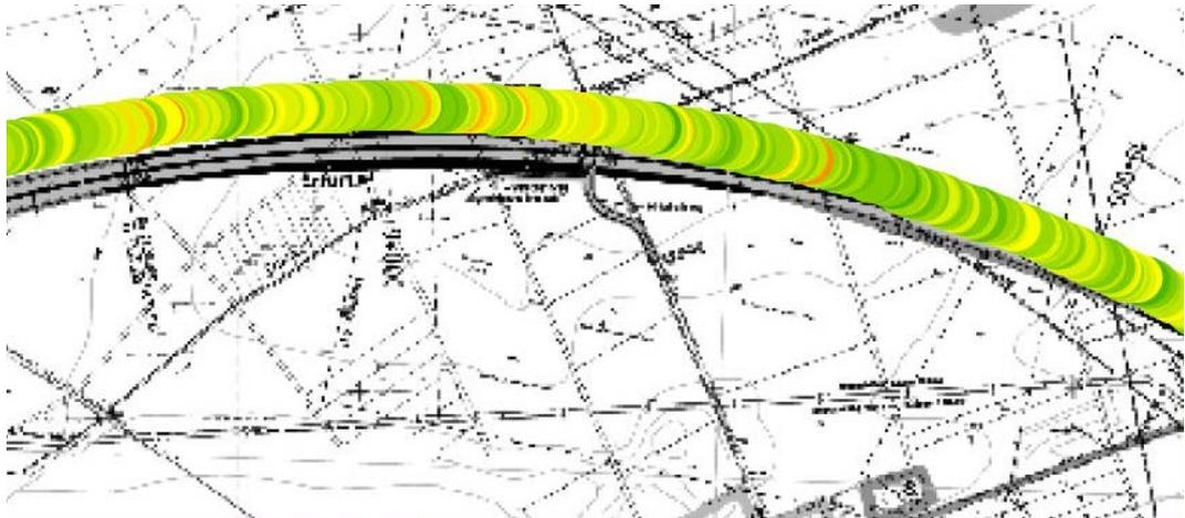
**Abb. 71** Beispiel einer georeferenzierte Darstellung von CPX-Messungen. Die Farbkodierung steht für den gemessenen Schalldruckpegel. Beachte die Abstände der farbigen Pegelkurve von der Messstrecke.
