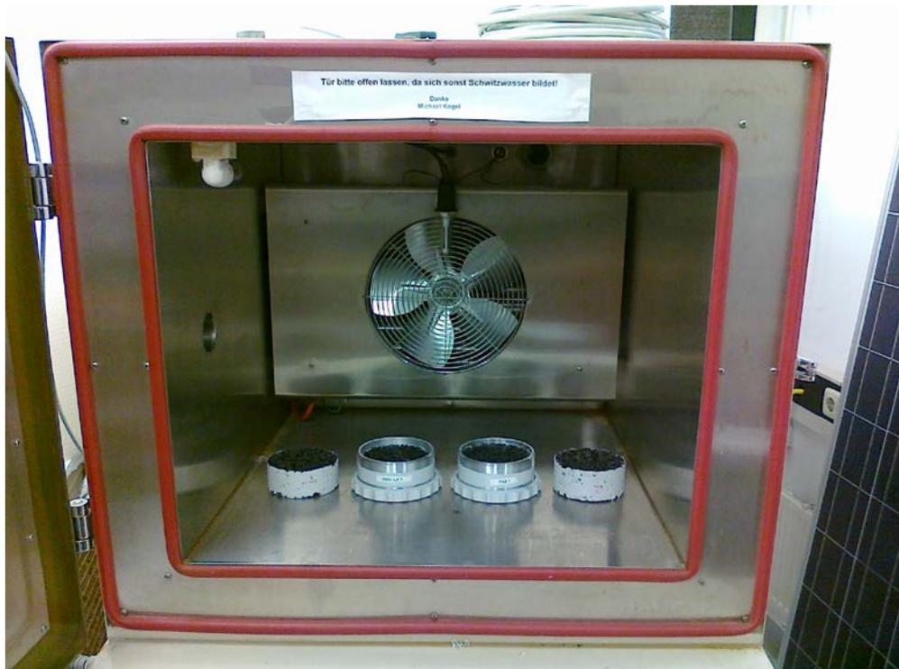
**Abb. 147** Probekörper im Klimaschrank.
