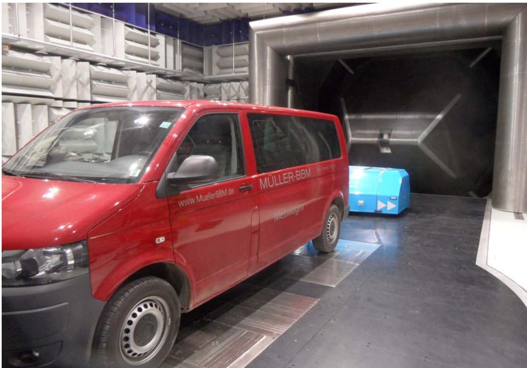
**Abb. 26** Messung im BMW Akustik-Windkanal mit Zugfahrzeug.
