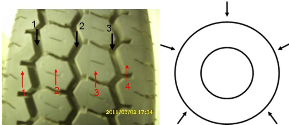
**Abb. 50** Messpunkte für Reifen vom Typ H (links) und Verteilung der Messprofile (rechts).
