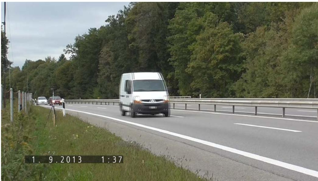
**Abb. 92** Vorbeifahrt eines Lieferwagens aus einer Videoaufzeichnung. Am linken Bildrand ist das Stativ der Dauermessstation zu sehen, links davon und ausserhalb des Bildausschnitts liegt der 7.5 m Messpunkt, in der Mitte zwischen Maschendrahtzaun und Fahrbahn steht das 5 m Mikrophon eines Messdienstleisters.
