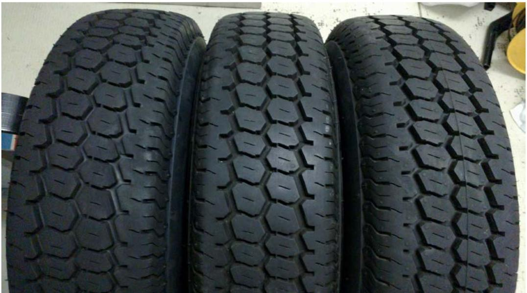
**Abb. 54** Messreifen H unmittelbar nach dem Einfahren (rechts), in der geringsten Verschleissstufe (2 mm, links) und ein alter Messreifen nach Ausmusterung aufgrund der Alterung (mittig).
