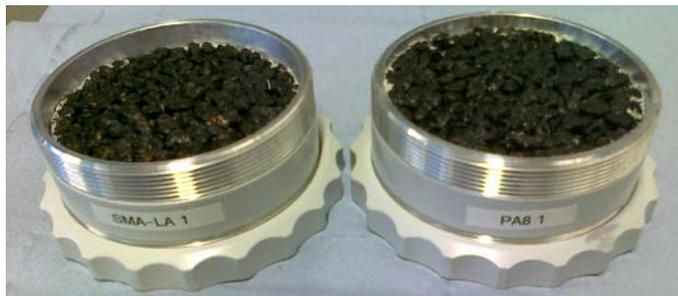
**Abb. 143** Asphaltbohrkerne im Probenhalter.
