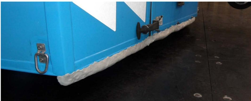
**Abb. 36** Kantengeometrie 3: Verrundung der nach unten gerichteten Kante.
