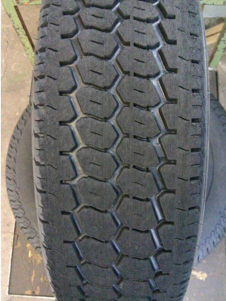
**Abb. 53** Frisch geschälter Reifen H mit Längsrillen durch den Schälvorgang und daher unrealistischer Reifenoberfläche.
