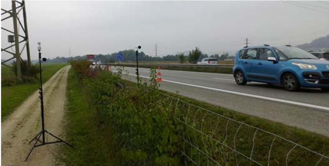
**Abb. 75** Mikrofonpositionen bei SPB-Messung mit Absicherung durch Kegel.
