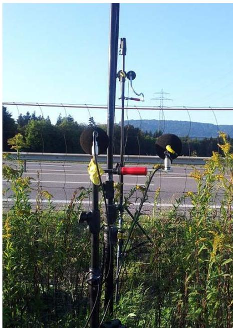
**Abb. 109** Mikrofonaufbau bei der Doppelmessung durch die Müller-BBM Schweiz AG. Im Vordergrund die 7.5 m Mikrofone, im Hintergrund, die 5 m Position. Jeweils links die Mikrofone der Messung mit korrekter Ausrichtung, rechts die SPB-Mikrofone der Messung mit verdrehter Geschwindigkeitsmesstechnik.
