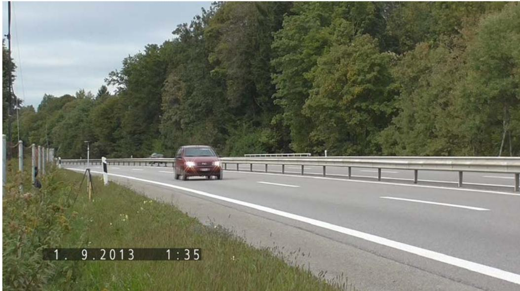
**Abb. 93** Vorbeifahrt eines Personenwagens aus der Perspektive der Videokamera. Am linken Bildrand ist das Stativ der Dauermessstation zu sehen, links davon und ausserhalb des Bildausschnitts liegt der 7.5 m Messpunkt, in der Mitte zwischen Maschendrahtzaun und Fahrbahn steht das 5 m Mikrofon eines Messdienstleisters.
