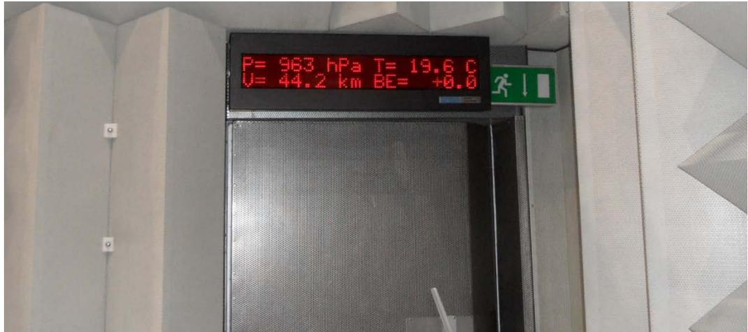
**Abb. 27** Anzeige im Windkanal für Luftdruck, Temperatur, Strömungsgeschwindigkeit.
