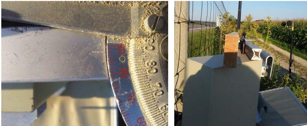
**Abb. 110** Die Ausrichtung des Geschwindigkeitsmessgeräts erfolgte mit Hilfe einer Winkelmesseinrichtung (links), die auf einer Holzplatte aufgeschraubt war, welche parallel zur Fahrbahn ausgerichtet wurde, während das Geschwindigkeitsmessgerät nach einem abweichenden Winkel (siehe Aluminiumprofilstange) ausgerichtet wurde (rechts).
