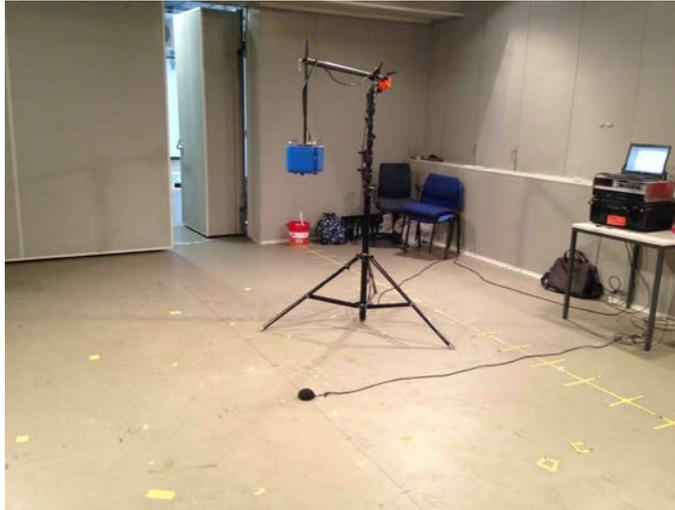
**Abb. 119** Messaufbau im schallabsorbierenden Raum mit reflektierendem Boden. Die Messsonde mit einem halbierten Windball liegt unterhalb des blauen Lautsprechers. Die Erzeugung des Messsignals und die Aufzeichnung des Schalldrucks und der Schallschnelle erfolgt mit spezieller Messelektronik und einem Laptop (rechts).
