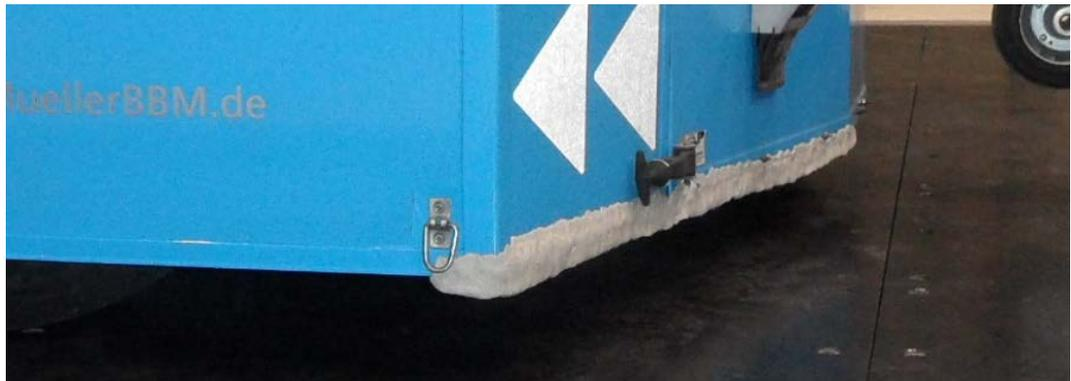
**Abb. 32** *Kantengeometrie 1: Verlängerte Schürze an der rechten Vorderkante.*
