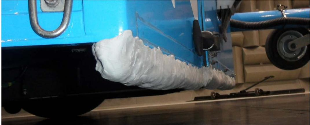
**Abb. 37** Kantengeometrie 3: Detailbild der Verrundung nach unten.
