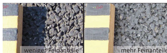
Fig. 3 : Deux revêtements semi-denses avec la même granulométrie maximale et la même teneur en vides (SDA 4-12), mais avec des fractions fines différentes (source : G + P).
