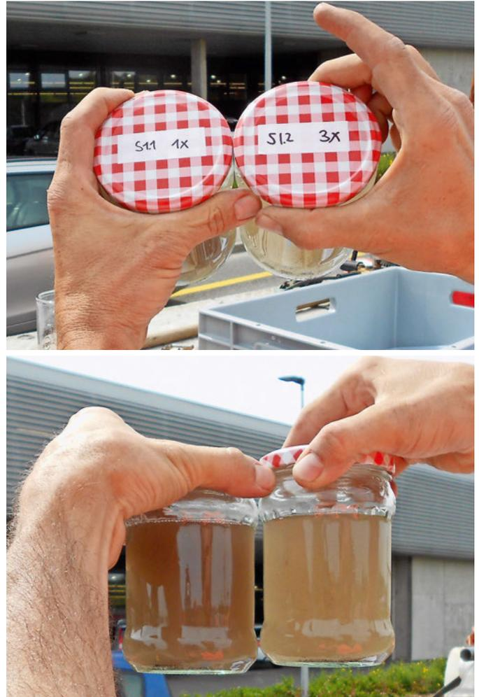
4 | Nach 1 Arbeitsgang (l.) bzw. nach 3 Arbeitsgängen (r.) abgesaugte Schmutzmenge.
