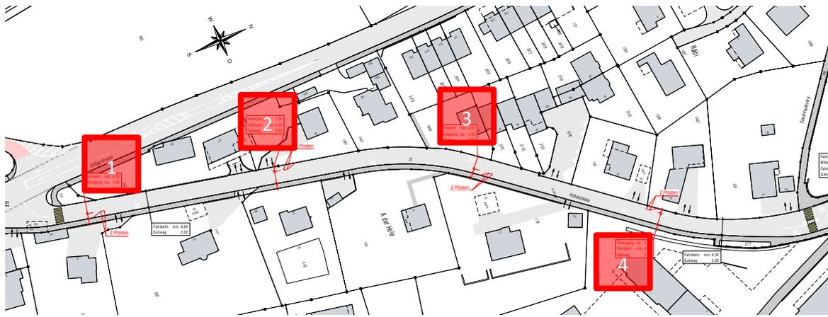
Abb. 27: Übersicht Phase 3 mit Nummerierung der seitlichen Einengungen
